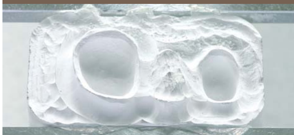
další detailní vnitřní frézování pomocí frézy 2L
