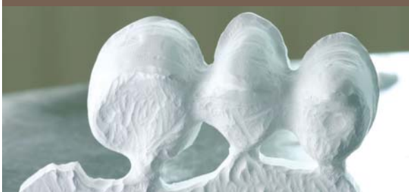
Vyříznutý můstek s podpůrnou základnou - připraven pro ponoření do barvicí tekutiny
