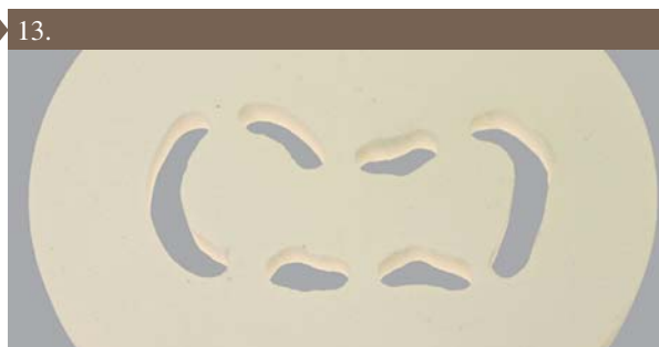
vybroušení tvrdokovovou frézou
