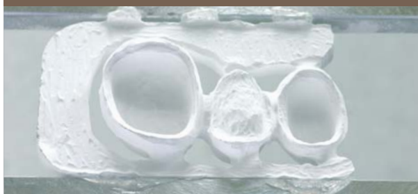
vyfrézovaný můstek – připravený k vyříznutí
