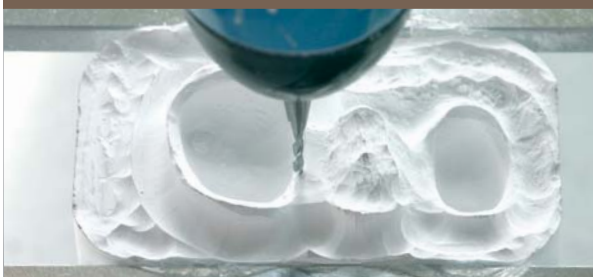
přesné vnitřní frézování a vyhlazení pomocí frézy 1L
